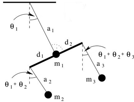
Fig. 10. Triple bar pendulum.
